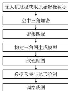
图2 三维立体模型测图流程图
